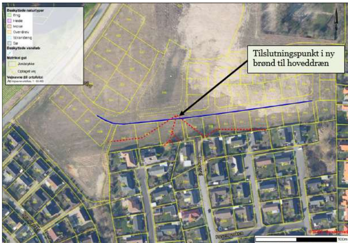
Figur 4. Omtrentlig placering af nyt dræn (blå linje), eksisterende dræn (røde, stiplede linjer), samt tilslutningspunkt i ny brønd. Af figuren fremgår desuden den nærmeste §3-beskyttede natur.
